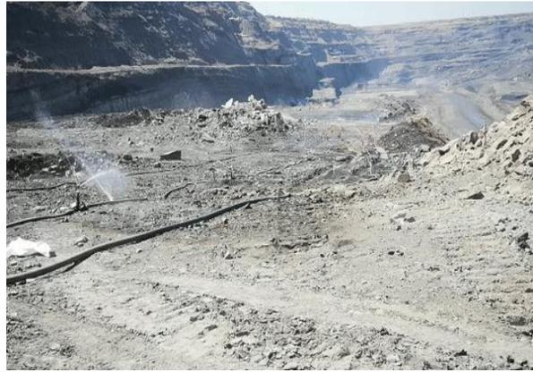
**Fotografías 4 y 5. Módulos de riego adicionales en avance de minería en Patilla y áreas de material caliente**
